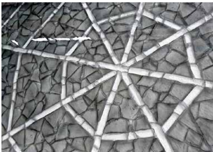
23. テクスチャーサンプル、ビルドを応用。CRT-c+t(廃ブラウン管リサイクルガラス)をデザインに合わせ構成。
