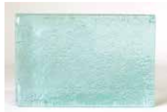
32. ガラスの片肌面に泡の様なテクスチャーをランダムに配置。FL (廃蛍光灯リサイクルガラス)、NX (廃ナトリウム灯リサイクルガラス)、クリアガラスを使用。150×100×T25mm / Φ170mm
