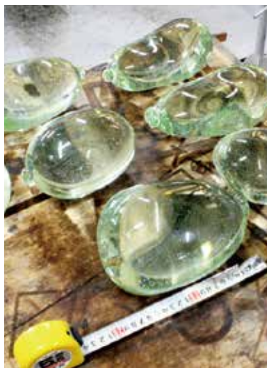
8. ブローワークで制作した石ころのような塊。最大長辺180mm程度の制作が可能。
