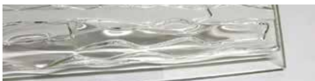
32. クリア板ガラスを波状に焼成し、高透過ガラスに合わせた作例。100×300mm
