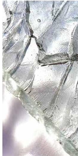
20. 流水をイメージ。サンプルテクスチャー、プラスターよりも表面の凹凸を多めに作成。 NX (廃ナトリウム灯リサイクルガラス)、CRT-c (廃ブラウン管リサイクルガラス) 使用。
