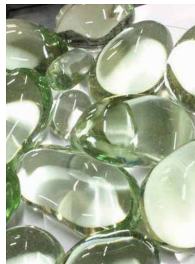
7. ホットキャスト制法、金型を使用し制作。よりガラスの流動性を楽しめるテクスチャーに。FL (廃蛍光灯リサイクルガラス) 使用。
