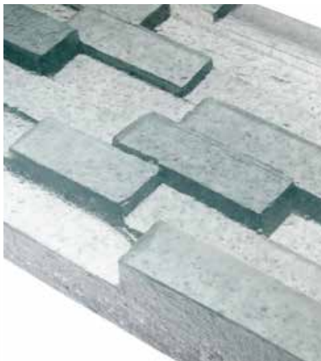
9. テクスチャーサンプル、プレーンをベースにレリーフ状に焼成。背面はフラット。CRT-c (廃ブラウン管ガラス) 使用。 400×150×T30mm
