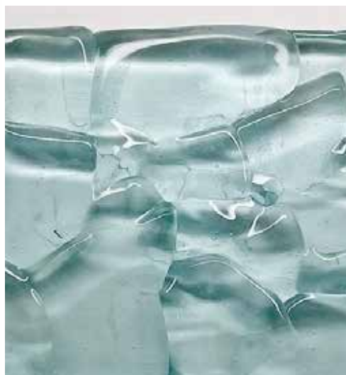
14. テクスチャーサンプル、バンピーをベースに凹凸を強めに制作。NX(廃ナトリウム灯リサイクルガラス)使用。
