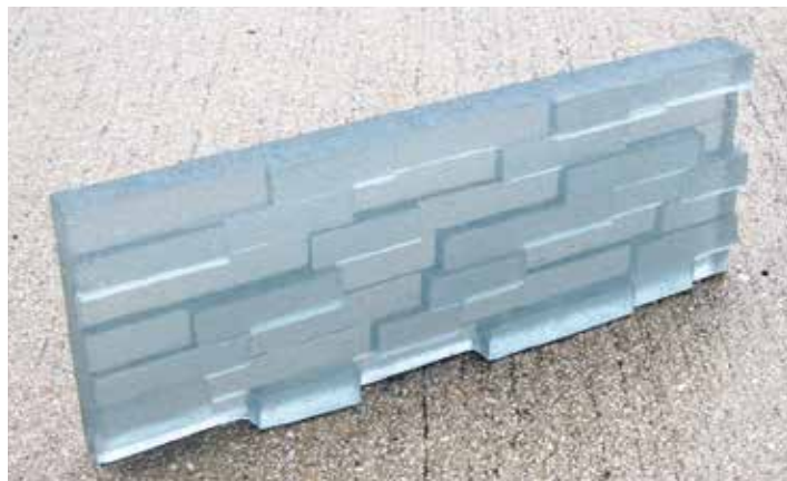
8. ブローワークで制作した石ころのような塊。最大長辺180mm程度の制作が可能。
