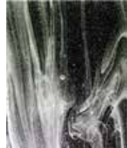
31. 細かな気泡の強弱により、水や煙を思わせる流動的な模様を表現。砕いた破片をランダムに配置する事も可能。 FL (廃蛍光灯リサイクルガラス) 使用。400×150×T30mm
