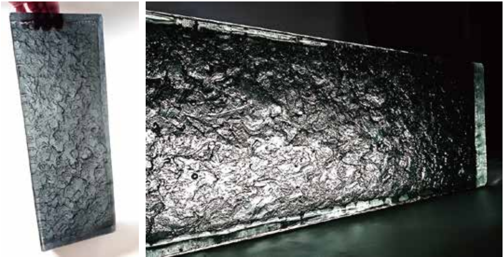
28. テクスチャーサンプル、プラスターの応用。ガラスの片肌面にランダムに模様をつけた作例。CRT-c(廃ブラウン管リサイクルガラス)使用。
