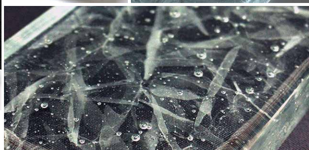
■ 名 称 : Flare-CRT-c ■ 使用ガラス : 廃ブラウン管(パネル)リサイクルガラス100% ■ 色・透明度 : 淡い灰色透明
