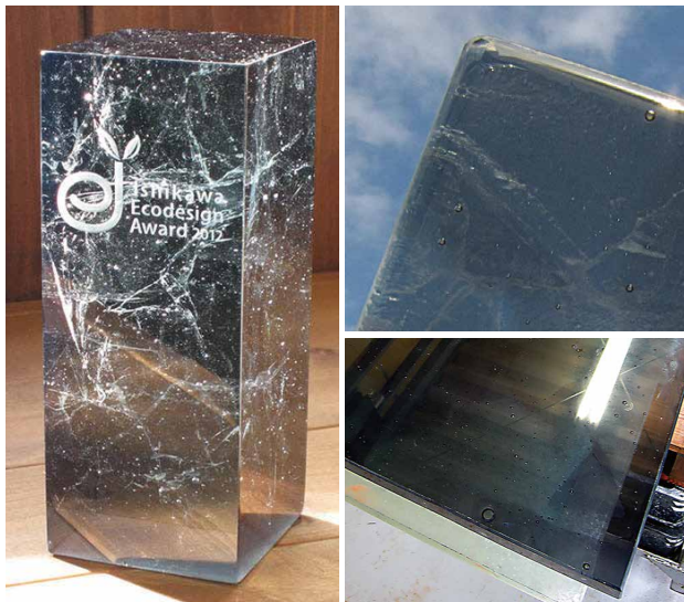
■ 名 称 : Build-CRT-t ■ 使用ガラス : 廃ブラウン管(パネル)リサイクルガラス100% ■ 色・透明度 : ■ 濃い 灰色透明
