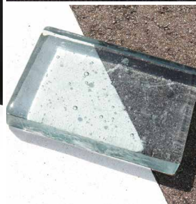
■ 名 称 : Drop-CRT-c ■ 使用ガラス : 廃ブラウン管(パネル)リサイクルガラス100% ■ 色・透明度 : 薄い灰色透明
