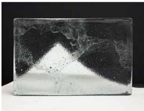
■ 名 称 : Icy-CRT-c ■ 使用ガラス : 廃ブラウン管(パネル)リサイクルガラス100% ■ 色・透明度 : 淡い灰色部分的に透明
