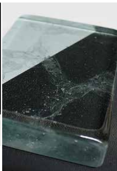
■ 名 称 : Icy-CRT-c ■ 使用ガラス : 廃ブラウン管(パネル)リサイクルガラス100% ■ 色・透明度 : 淡い灰色部分的に透明
