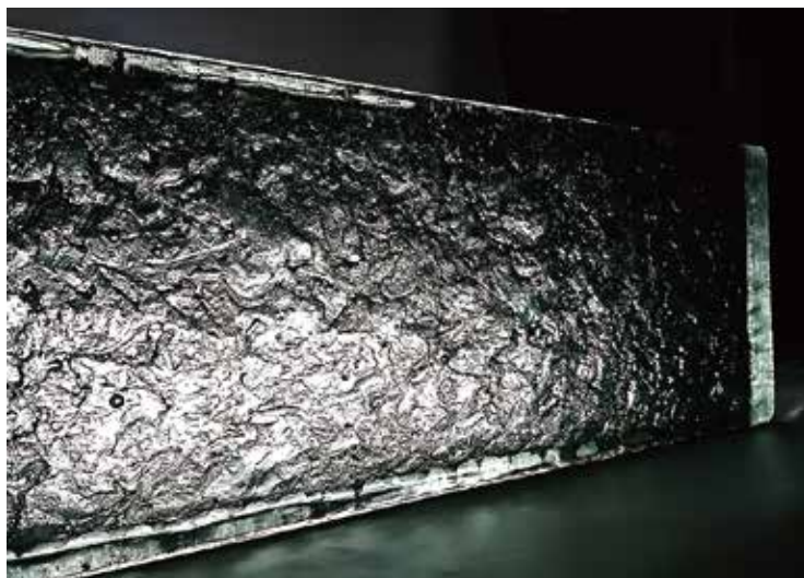
28. テクスチャーサンプル、プラスターの応用。ガラスの片肌面にランダムに模様をつけた作例。CRT-c (廃ブラウン管リサイクルガラス) 使用。
