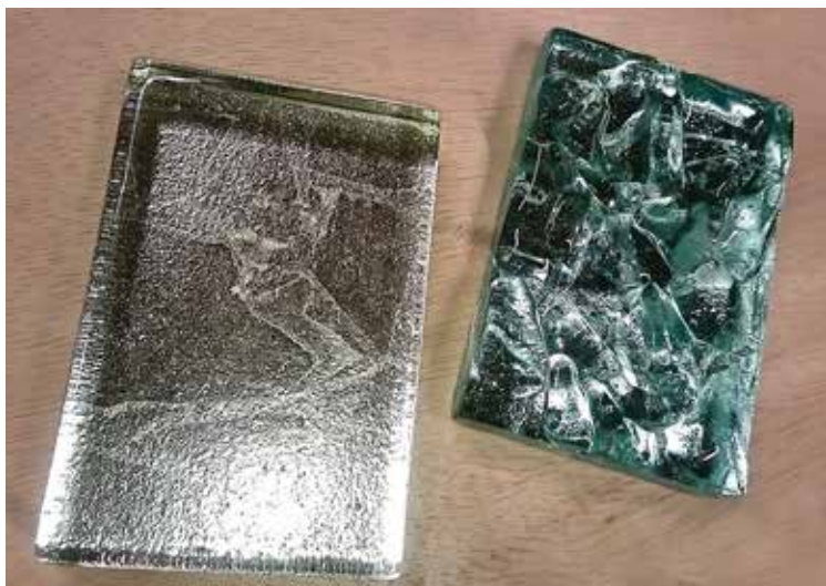
16. ガラスの背面に銀引き加工。
