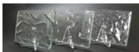
28. テクスチャーサンプル、プラスターの応用。ガラスの片肌面にランダムに模様をつけた作例。CRT-c (廃ブラウン管リサイクルガラス) 使用。
