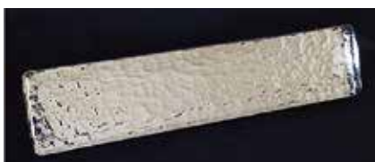
30. ガラスの型肌面に銀鏡加工した作例。CRT-c (廃ブラウン管リサイクルガラス) 使用。
