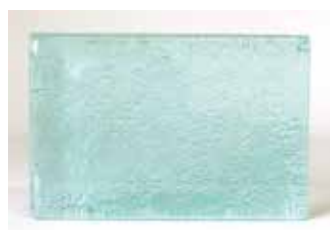
32. ガラスの片肌面に泡の様なテクスチャーをランダムに配置。FL (廃蛍光灯リサイクルガラス)、NX (廃ナトリウム灯リサイクルガラス)、クリアガラスを使用。150×100×T25mm / Φ170mm
