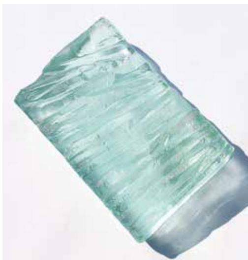
20. 流氷をイメージ。サンプルテクスチャー、プラスターよりも表面の凹凸を多めに作成。 NX (廃ナトリウム灯リサイクルガラス)、CRT-c (廃ブラウン管リサイクルガラス) 使用。
