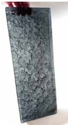
28. テクスチャーサンプル、プラスターの応用。ガラスの片肌面にランダムに模様をつけた作例。CRT-c (廃ブラウン管リサイクルガラス) 使用。
