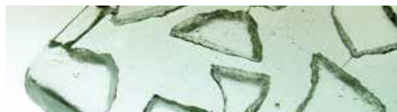
7. ホットキャスト制法、金型を使用し制作。よりガラスの流動性を楽しめるテクスチャーに。FL (廃蛍光灯リサイクルガラス) 使用。
