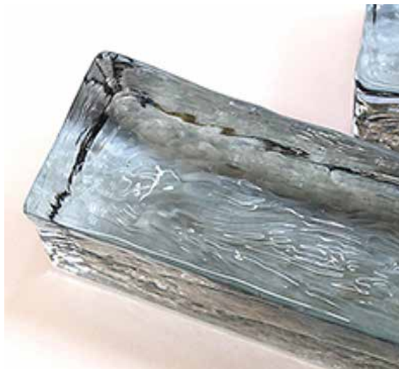
18. CRT-c(廃ブラウン管リサイクルガラス)を使用したブロック。210×50×T40mm≒約1.2kg
