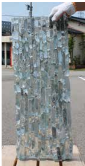
10. パーツを合わせ、岩肌を表現。背面はフラット。CRT-c(廃ブラウン管リサイクルガラス)使用。
