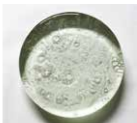
31. 細かな気泡の強弱により、水や煙を思わせる流動的な模様を表現。砕いた破片をランダムに配置する事も可能。 FL (廃蛍光灯リサイクルガラス) 使用。400×150×T30mm
