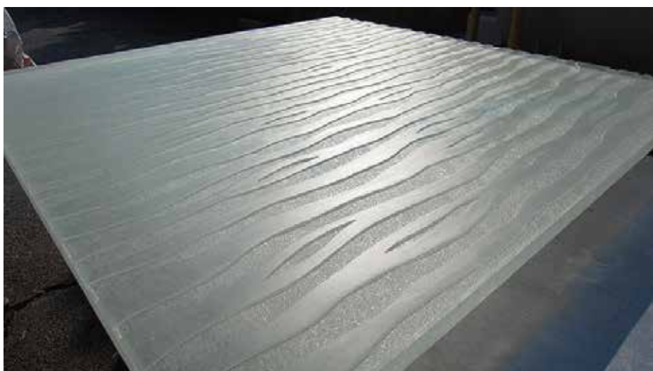
5. テクスチャーサンプル、プレーンをベースにレリーフ状に焼成。FL(廃蛍光灯リサイクルガラス)使用。
