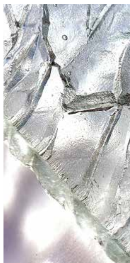
20. 流氷をイメージ。サンプルテクスチャー、プラスターよりも表面の凹凸を多めに作成。 NX (廃ナトリウム灯リサイクルガラス)、CRT-c (廃ブラウン管リサイクルガラス) 使用。
