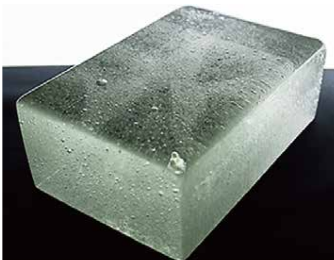
17. 泡を調整して時を止めた様な透明感を演出。テクスチャーサンプル、アイシーをベースに制作。 FL(廃蛍光灯リサイクルガラス) 使用。
