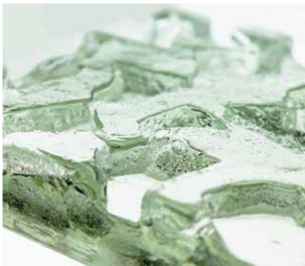
7. ホットキャスト制法、金型を使用し制作。よりガラスの流動性を楽しめるテクスチャーに。FL (廃蛍光灯リサイクルガラス) 使用。
